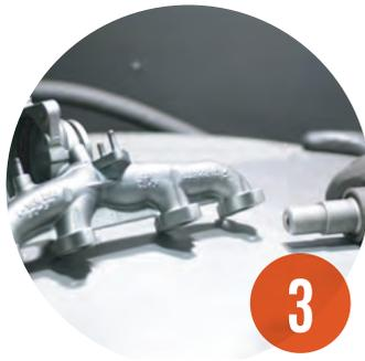
Rimozione di impurità, ruggine ed olii sinterizzati mediante sabbiatura degli elementi della turbina.
