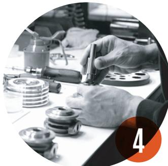
Misurazione e calibrazione delle parti da sostituire.
